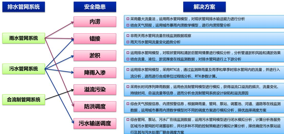
圖 4-27 基於在綫監測與模型模擬的安全管理解決方案
